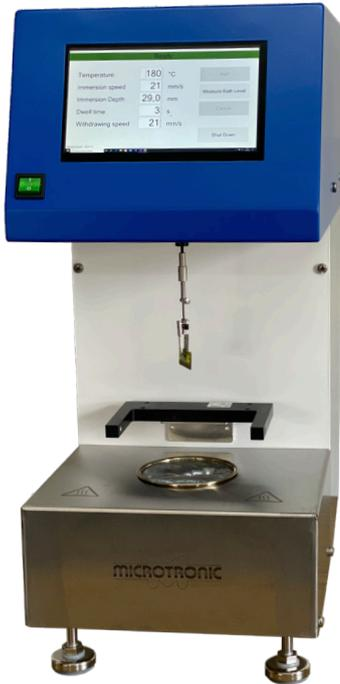
Für die Qualifikation von Leiterplatten wird bei manchen Test-Standards ein Testcoupon verwendet. Dieser soll immer gleich, mit bestimmten Parametern, in ein Lotbad getaucht werden. Danach wird optisch begutachtet, wie weit das Lot auf den Pads nach oben gewandert - benetzt - ist. Dafür stellen wir den neuen D&L Automator vor. Hier steht das D&L für Dip and Look.
