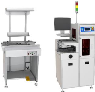
Manuelle Arbeitsplätze (Bild links) oder Inline Reparatur und Meßplätze (Bild rechts) vereinfachen evtl. nötige Arbeitsschritte in der Linie. Speziell die Reparaturstationen sind vielseitig einsetzbar. Sie können bestimmte Baugruppen aus der Linie nehmen und an einen Arbeitsplatz heben. Auf dem dazugehörigen Display lassen sich Arbeitsanweisungen oder Fehlerbilder von vorangegangenen Systemen wie AOI, Meßsystemen und Anderen anzeigen.
